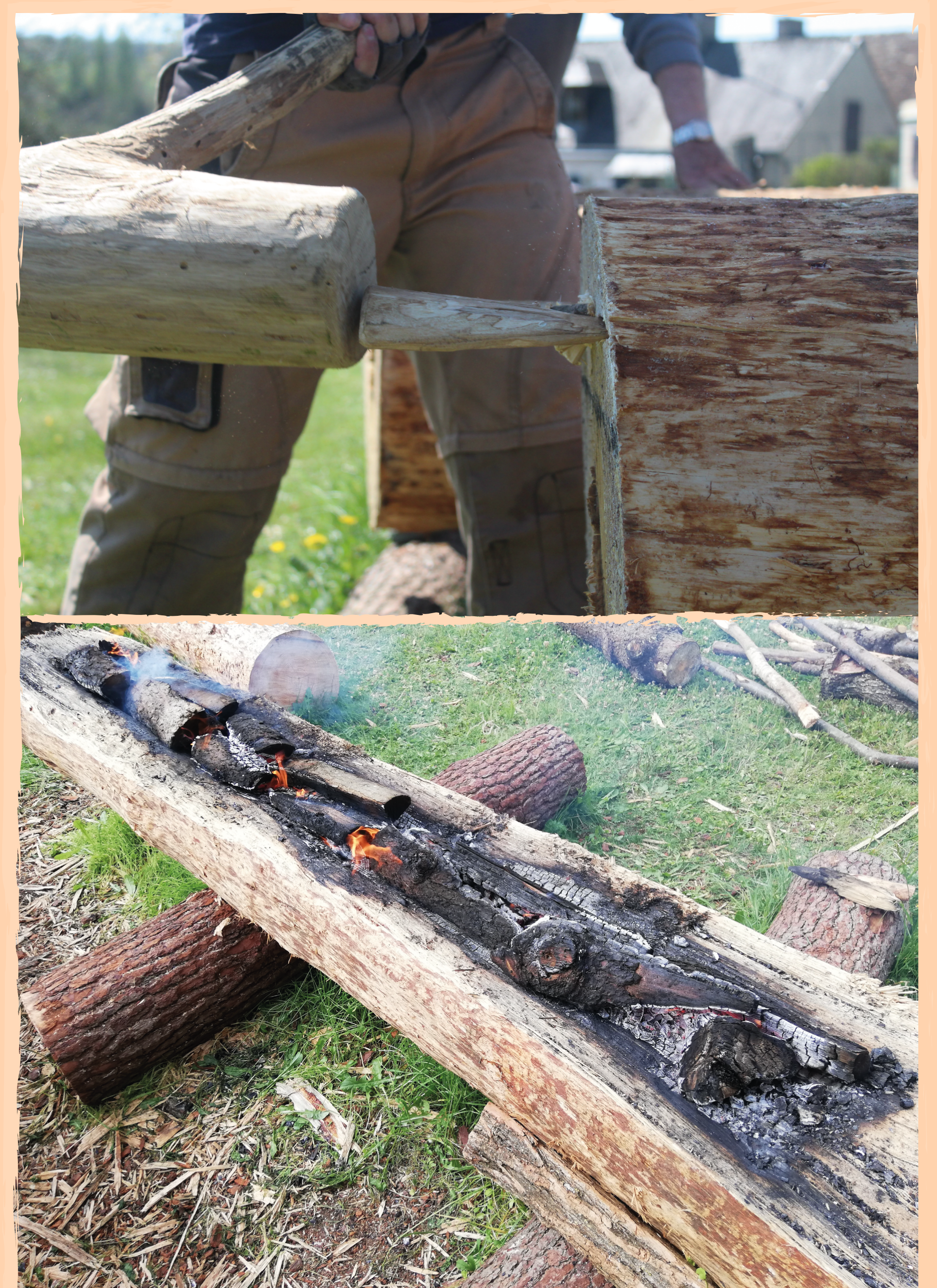
Haut : Refente de la grume à l'aide d'une masse et d'un coin en bois. Bas : Creusement au feu d'une pirogue monoxyle. Crédits : APERA.
